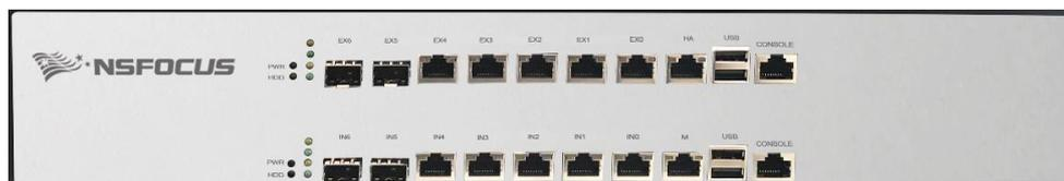
针对两化融合应用场景下生产网和管理网之间安全交换需求，绿盟科技基于十多年安全隔离网闸的技术积累和行业应用经验，推出了绿盟科技工业安全隔离装置。
