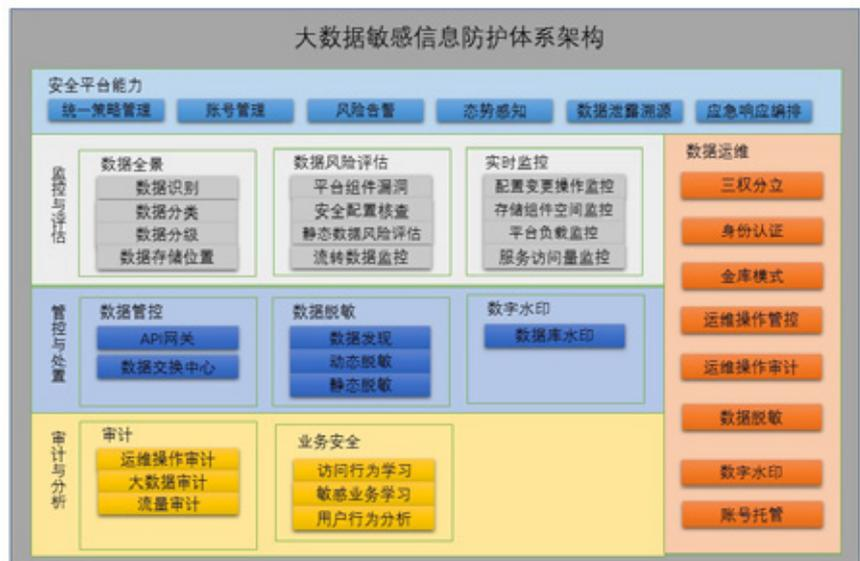
安全平台对接设备，集中管理、日志收集、智能分析，拥有统一策略管理、账号管理、风险告警、态势感知、数据泄露溯源、应急响应编排能力。
